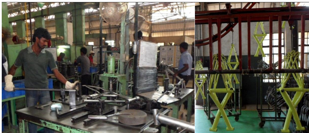
Figura 57c: Ajuste manual del cuadro y pintura robótica y manual en una fábrica hindú. - Embajada Ecuador- Países Bajos (2012)
